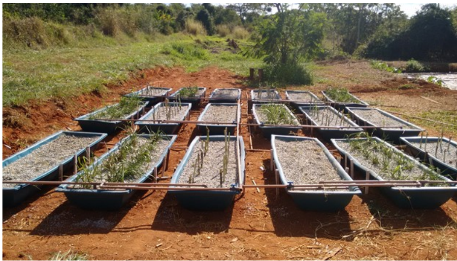
Figura 4 – SACs preenchidos com meio suporte com as mudas dos diversos capins utilizados. Fonte: A autora. 2018.
