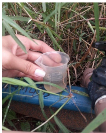
Figura 5 – Método direto de medir vazão (recipiente graduado).
